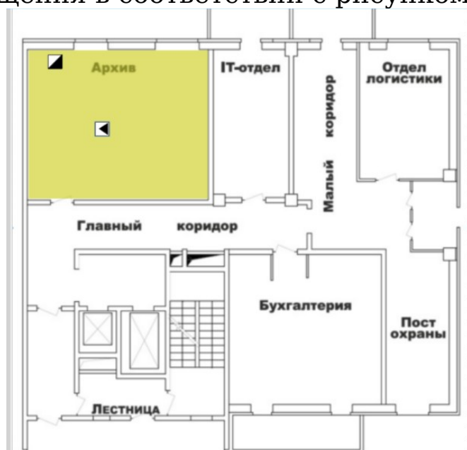
Рисунок Б.29 – Расположение устройств в зоне «Архив»
