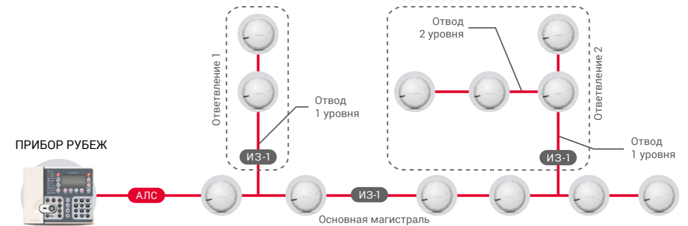
Схема радиальной с ответвлениями топологии адресных линий связи
