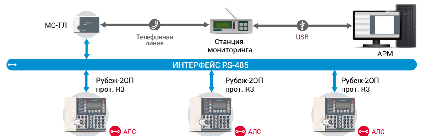
Схема передачи извещений от приборов интерфейса RS-485 на мониторинговые станции по телефонной линии
