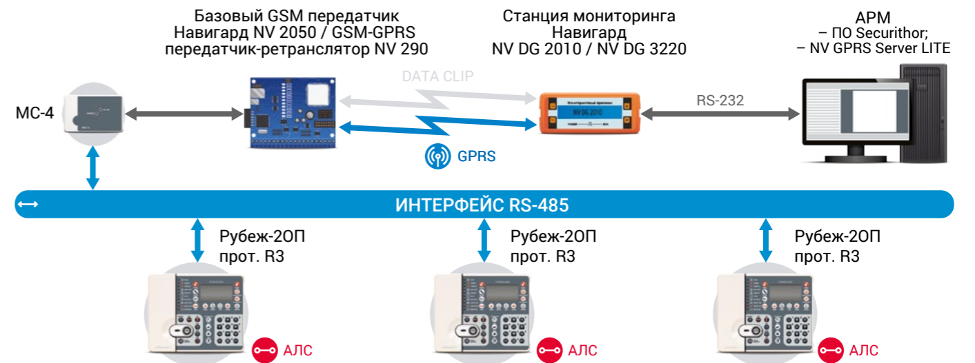
Схема передачи извещений от приборов интерфейса RS-485 на мониторинговые станции по GPRS
