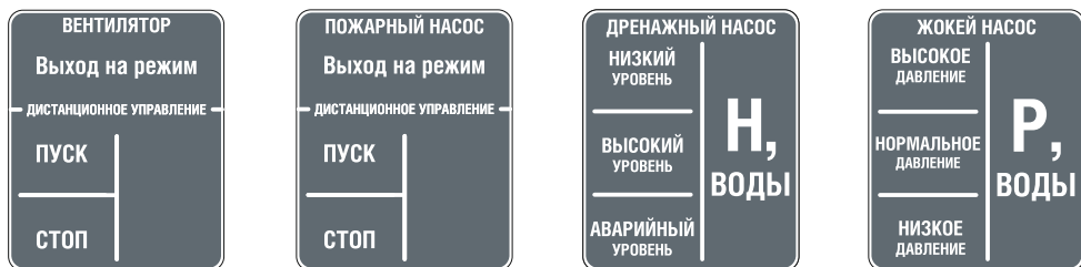
Рисунок 5 – Сменная этикетка панели управления ШУ
