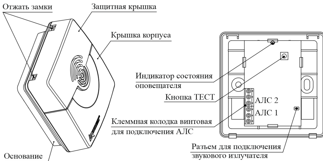
Рисунок 3.5.2.2 – Корпус и плата оповещателя
