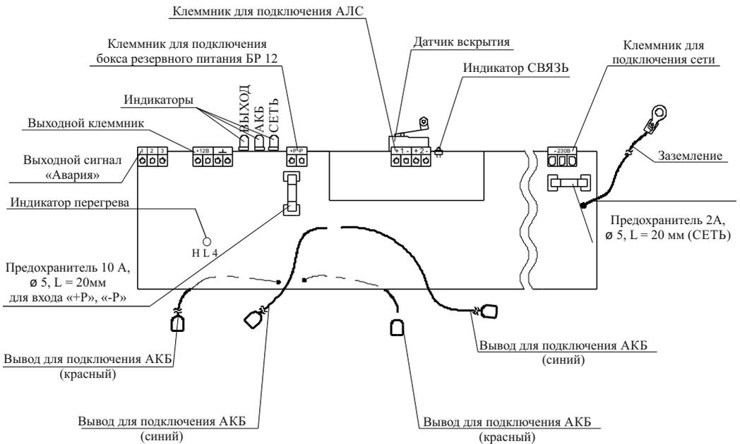
Рисунок 1 – Плата источника
