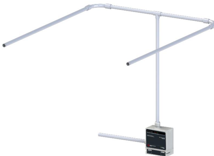
Рисунок 3 – Воздухозаборный трубопровод с 2 симметричными ветвями
