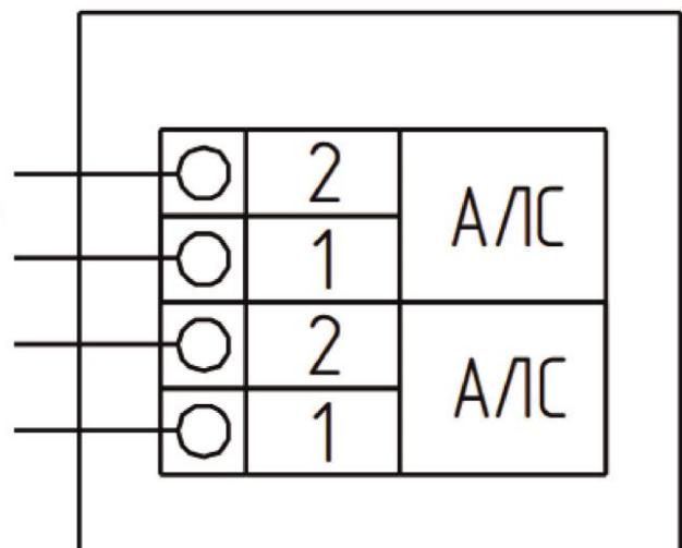
Рисунок 9 - Схема соединения извещателя с ППКОПУ
