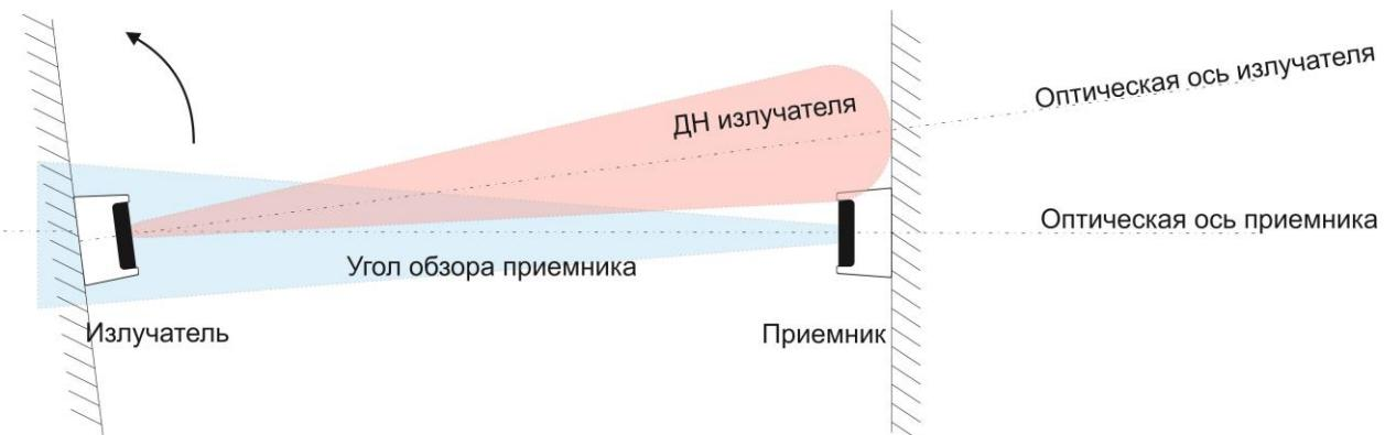
Пропадание или уменьшение сигнала из-за подвижек здания и, как следствие, формирование ложного извещения о пожаре или неисправности
