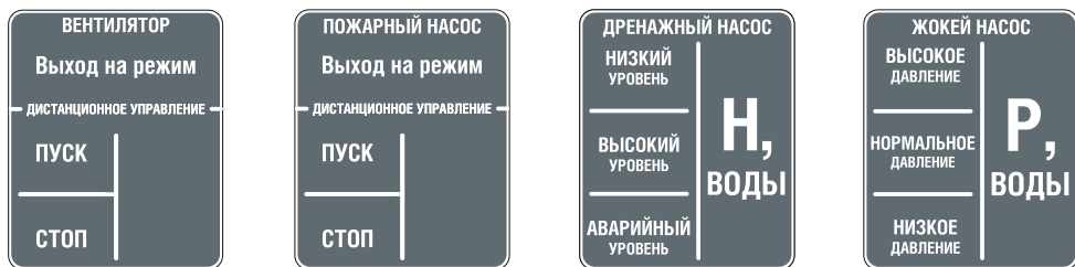
Рисунок 5 – Сменная этикетка панели управления ШУ
