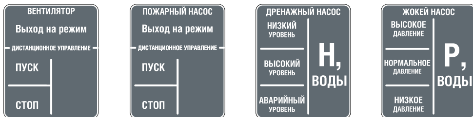
Рисунок 5 – Сменная этикетка панели управления ШУ
