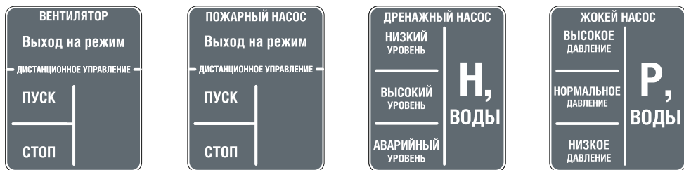
Рисунок 5 – Сменная этикетка панели управления ШУ
