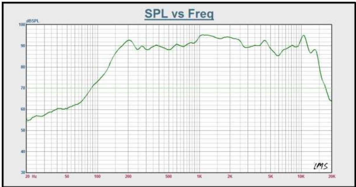
Рисунок 2 - Амплитудно-частотная характеристика SCS-820
