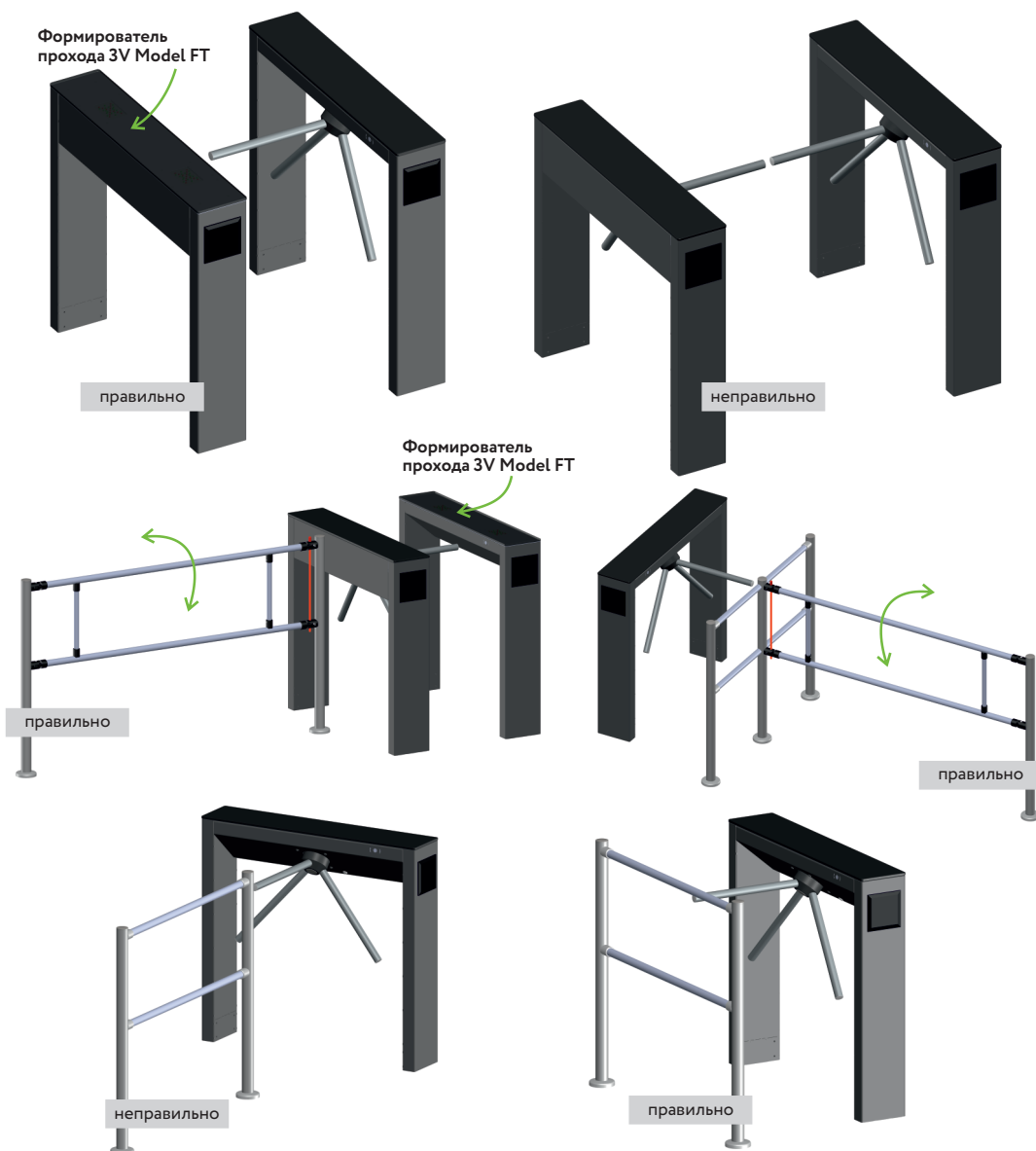
Рисунок 9.1 - Пример правильного и неправильного монтажа турникета
