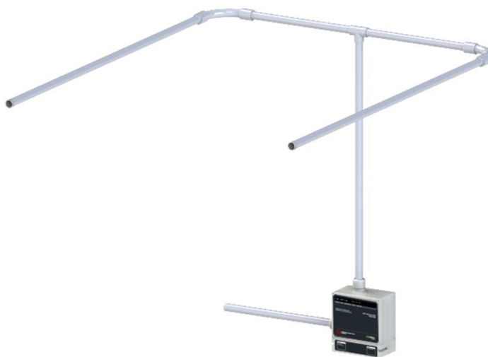
Рисунок 3 – Воздухозаборный трубопровод с 2 симметричными ветвями
