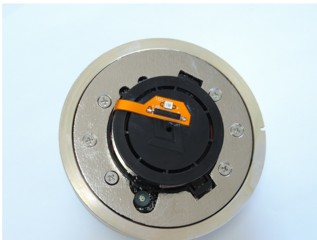
Рисунок А.4 – Вид измерительного блока (фланца) сверху. На дымовой камере расположена гибкая плата со светодиодом и герконом для адресации прибора
