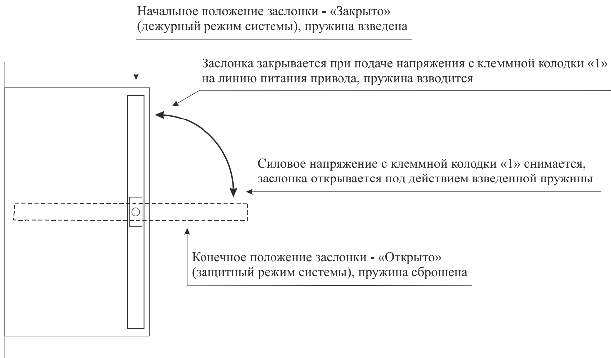
Рисунок 4.6 – Пример схемы реализации функции «Дымоудаление» для привода с возвратной пружиной
