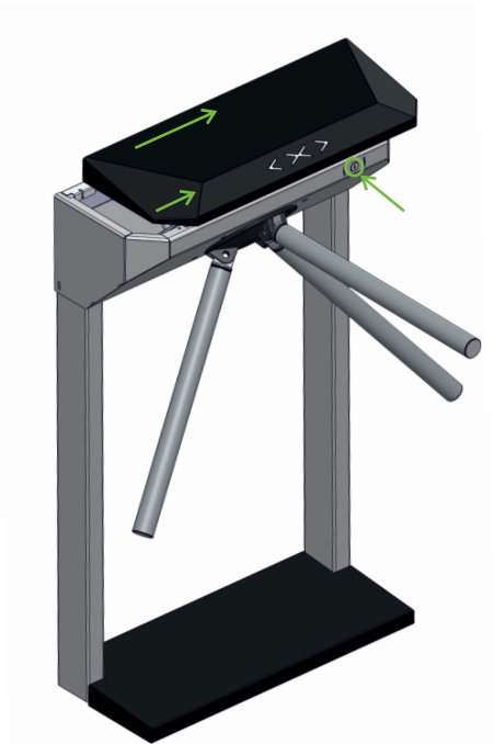
Рисунок 9.7 - Открытие крышки корпуса на примере 3V Model R(a)
