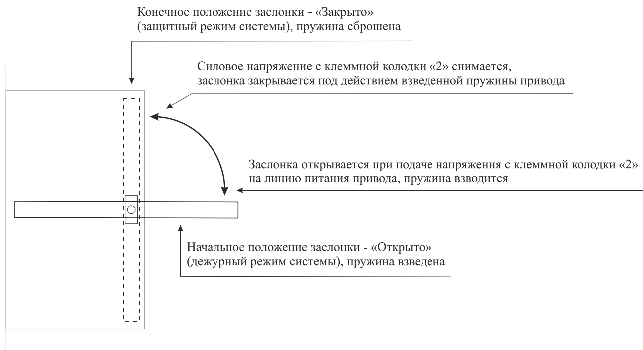
Рисунок 4.7 – Пример схемы реализации функции «Огнезащита» для привода с возвратной пружиной
